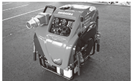
消防用の小型ポンプ
